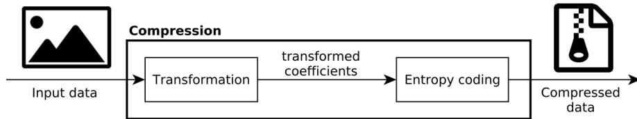
Figure 7.2: Pipeline formado por una transformada y un entropía codificador
